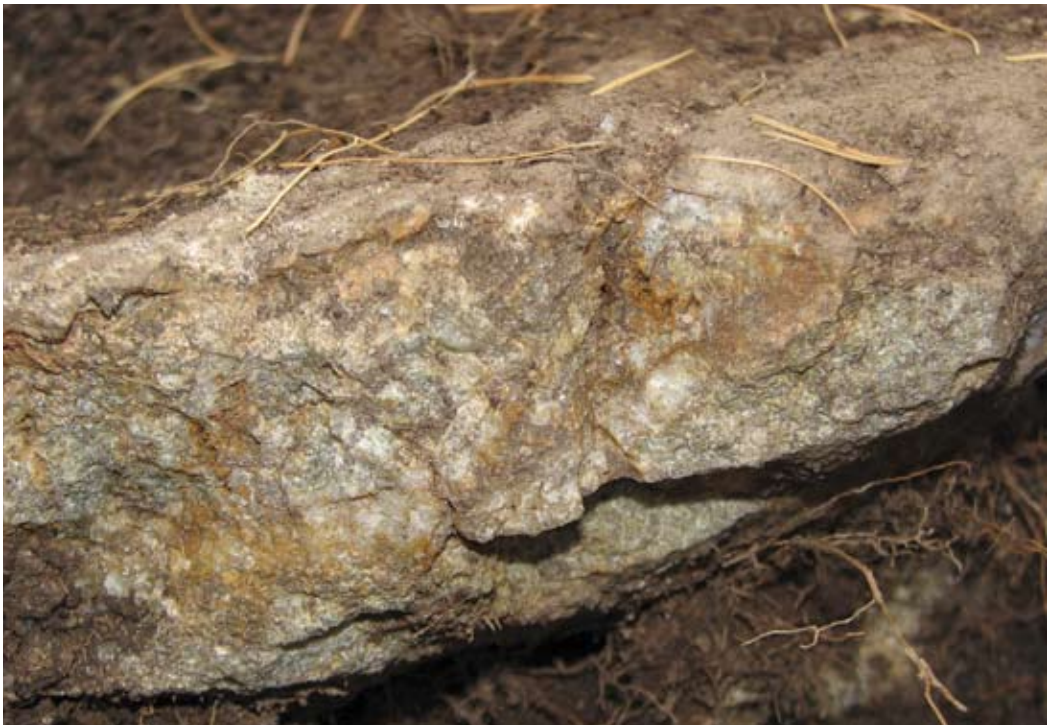
På Tardan 2 fastställdes under sovjettiden guld i smala kvartsgångar. En sådan syns här. Kvartsgångarna bedömdes för små för att rymma ekonomiskt utvinningsbart guld, d v s malmer.
